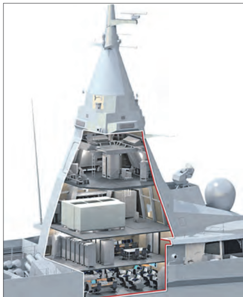
Схема размещения радиоэлектронного вооружения, центра обработки данных и главного командного пункта в мачте фрегата типа «Ронарх»
