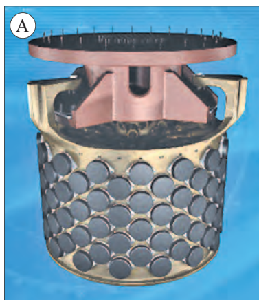
Внешний вид гидроакустических станций ФР типа «Ронарх»: А – антенна корпусной ГАС «Кингклип Mk2»; Б – буксируемая ГАС «Каптак-4 Компакт» в сравнении с обычной ГАС «Каптак-4»
