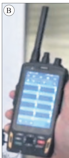
А – интерфейс ПО «Партнер-С» на терминале управления; Б – стационарный терминал системы связи «Комтикс»; В – переносной терминал смартфонного типа системы связи «Комтикс»
