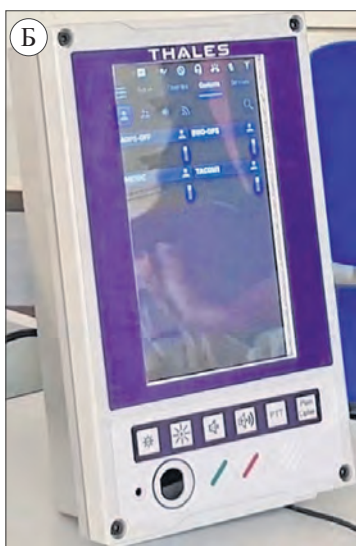
А – интерфейс ПО «Партнер-С» на терминале управления; Б – стационарный терминал системы связи «Комтикс»; В – переносной терминал смартфонного типа системы связи «Комтикс»
